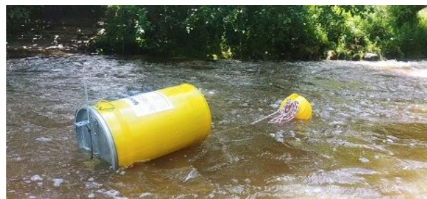
Abbildung 3: links: Sauerstoffmessgeräte, rechts: Messboje für die Messung von Umweltparametern (Quelle: IBF Umwelt)
