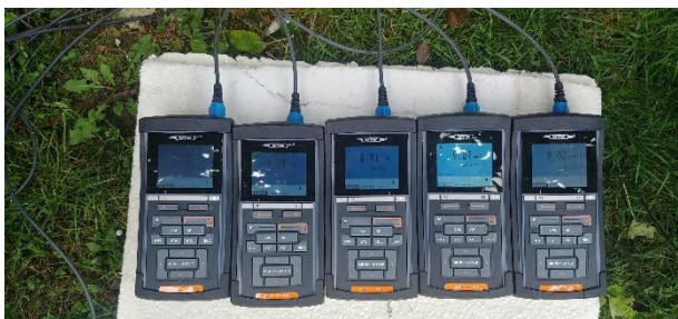
Abbildung 3: links: Sauerstoffmessgeräte, rechts: Messboje für die Messung von Umweltparametern (Quelle: IBF Umwelt)
